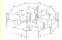
構造は蟻塚の構造を参考にしていて、現地の素材をそのまま使える点や、寒暖差の大きいサバンナにおいて内部の気温を一定に保てるなどのメリットがある。 内部の版築の壁と外部の土の屋根の間に空間があることで、煙突効果を生み出している。
